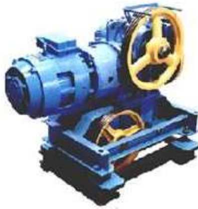
Рисунок 1 – Редукторный электропривод лифта с двухскоростным асинхронным двигателем
