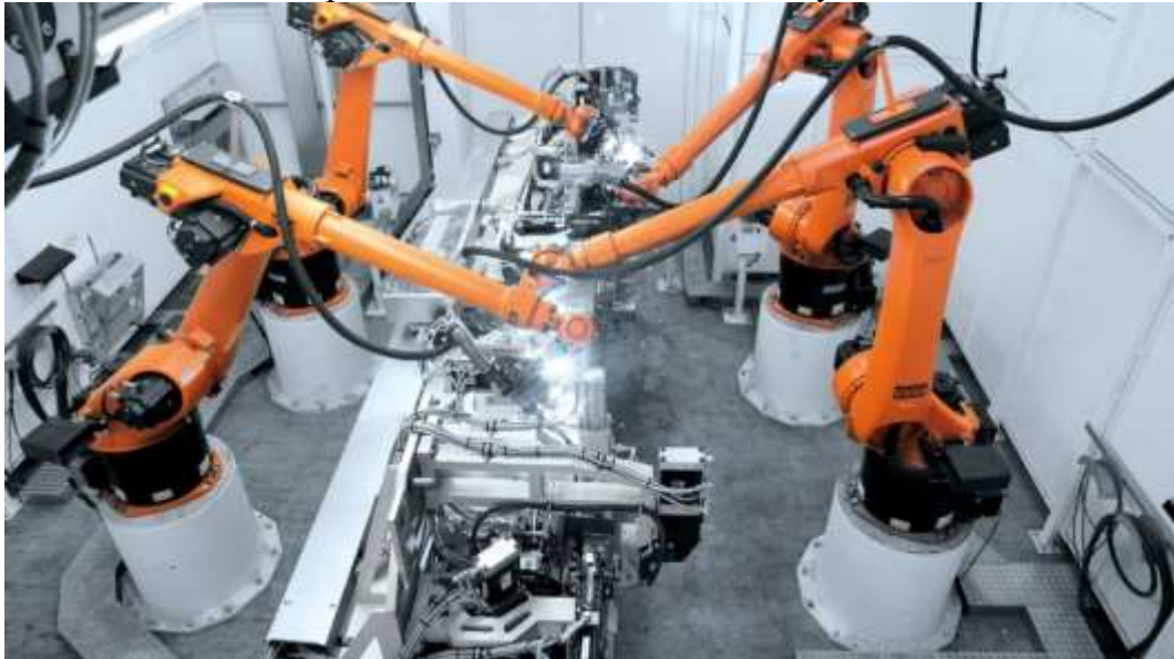
Рисунок 9 — Применение шарнирных манипуляторов на производстве
